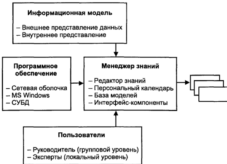
Рис. 4.3. Обобщённая структура мультиагентной системы принятия решений «Multi Expert»
