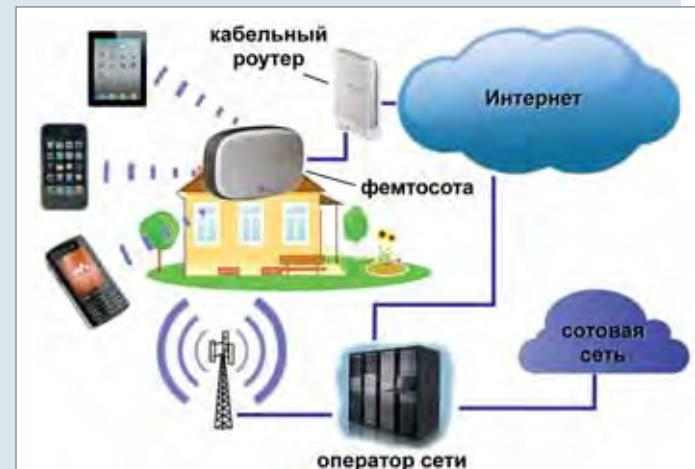
► Схема функционирования фемтосоты
