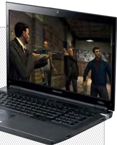
числе связанных с развлечениями, ведь в качестве видеоподсистемы выступает графический адаптер ATI Radeon HD 6970M, имеющий 2 Гбайт собственной видеопамяти. Еще одно интересное решение — использование технологии ExpressCache, позволяющей с помощью встроенного твердотельного накопителя объемом 8 Гбайт сократить время выхода из режима гибернации.
