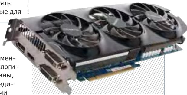
мм вентиляторами, после прохождения через ребра радиатора расходятся в разные стороны от платы, не нагревая ее поверхность.
