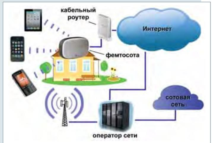
► Схема функционирования фемтосоты
