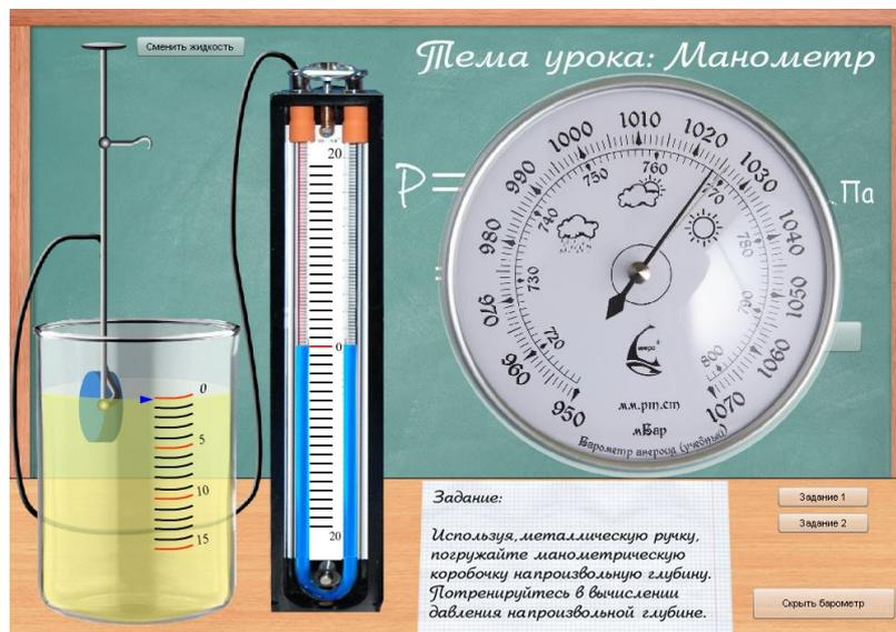
Рис. 2. Модель «Манометр». Измерение давления внутри жидкости манометром и атмосферного давления барометром-анероидом (разработка студента физического факультета ПГГПУ А.Васильченко)
