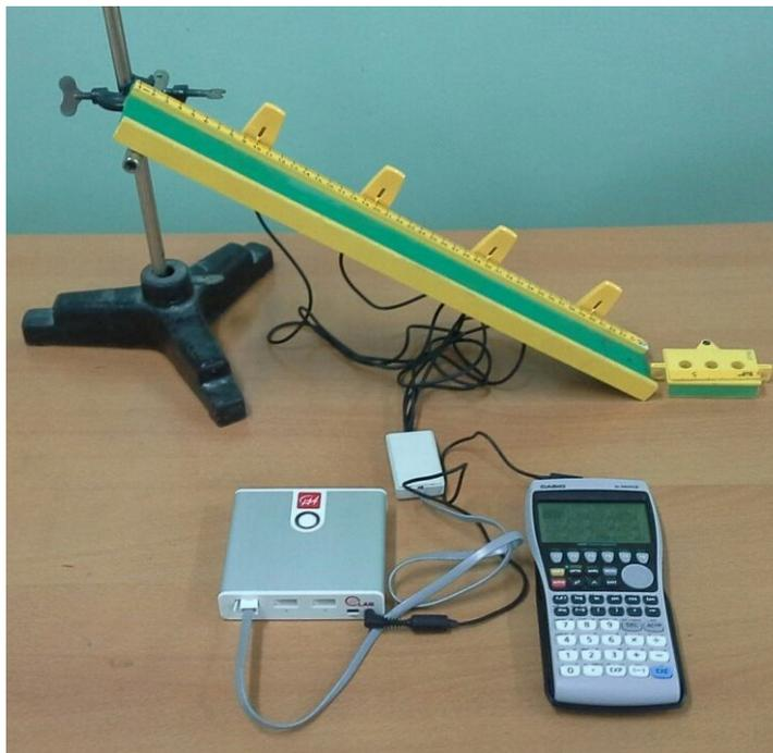
Рис. 2. Лабораторная установка по механике на основе CASIO fx-9860CII и CLab.
