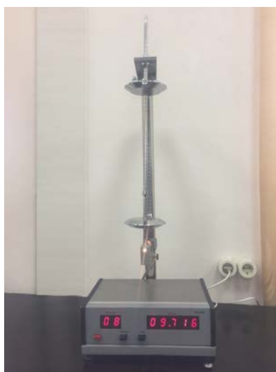
Рис. Установка польского класса “ELWRO” по исследованию колебаний физического маятника
