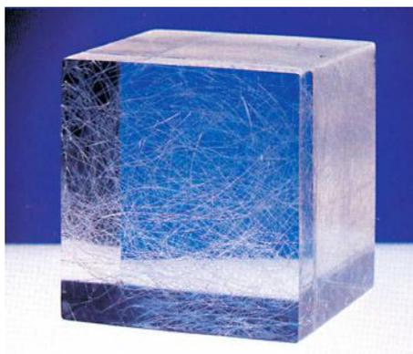
Стеклофибра – еще один вид дисперсного (распределенного в среде) армирования бетонной смеси. Благодаря звукоотражающим свойствам и высокой прочности (таблица 2) стеклофибробетон неза-
