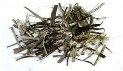
Базальт — продукт переработки в каменном литье, то есть созданный из природного камня; он имеет очень хорошие показатели по химической стойкости. Волокна  $\varnothing$  16–18 мкм имеют стопроцентную стойкость к воде [5, 9, 12].
