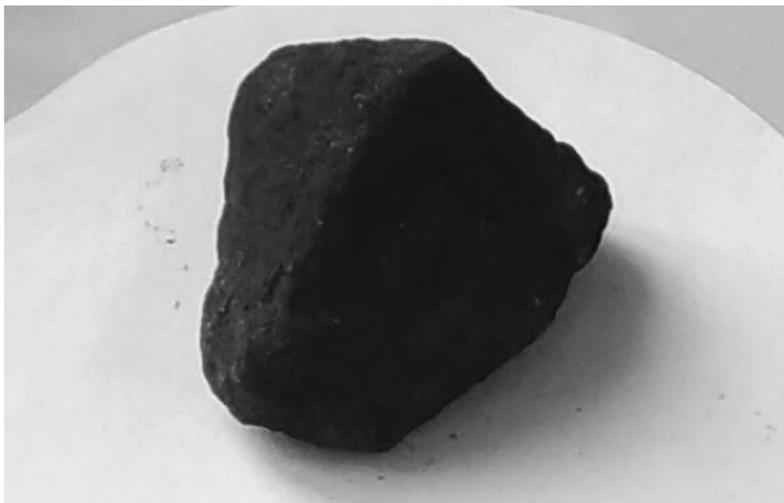
Рис. 1. Образец нефтесмазученного щебня, взятый с балластной призмы железнодорожных путей
