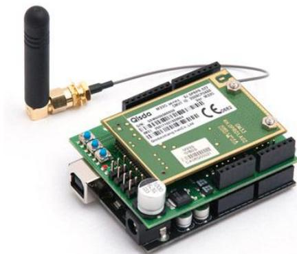
Cosmo GSM Connect способен отправлять и принимать sms-сообщения и производить GPRS-соединения как с компьютера, так и с помощью микроконтроллера.
