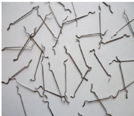
Стальная фибра применяется в монолитных железобетонных конструкциях и сборных конструкциях изготовленных на заводе.
