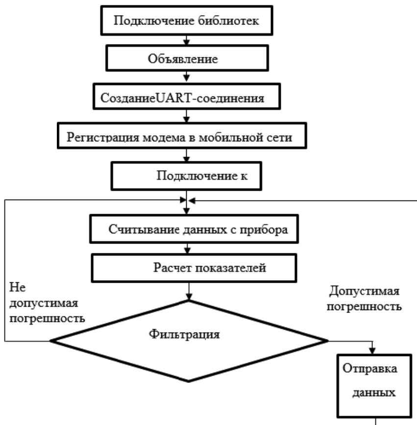
Рис. 45. Логическая схема работы программного обеспечения прибора
